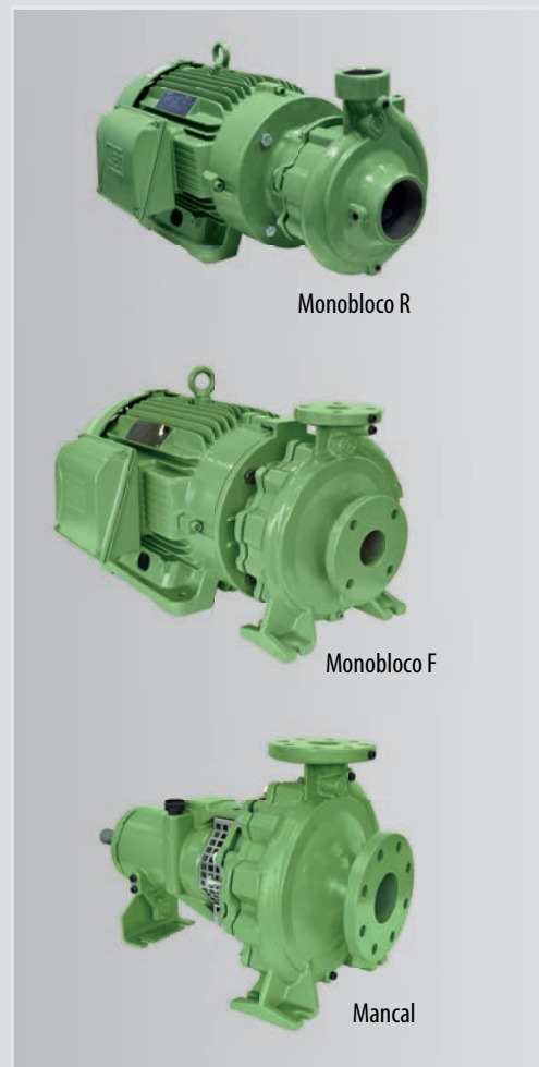
Motor WEG IP-55, 2 polos, 60 Hz Rotor fechado de ferro fundido Para bombeamento de água acima de 70 °C, utilize selo mecânico de Viton® Modelo R: bocais roscados. Modelo F e Mancalizada: bocais flangeados conforme Norma ANSI B16.1. MANC: Mancais.
